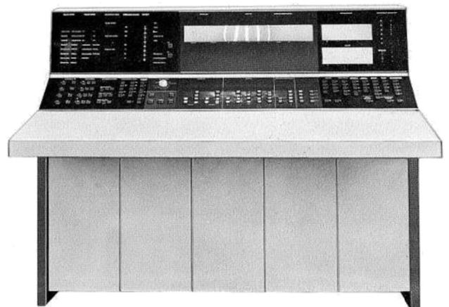
Bemerkenswert war die Ausführung der Anzeigefelder. Für jede Stelle eines Anzeigefeldes - die Befehlsanzeige in der Mitte umfasste 13 Stellen - gab es eine optische Projektion der Symbole 0...3 bzw. 0...9. Erreicht wurde dies, durch eine 1 aus 10- Entschlüsselung und die Ansteuerung von 10 Glühlampen mit vorgebauten Masken.
